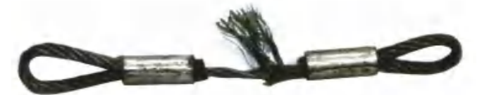
Breaking force test result 破坏性实验结果
